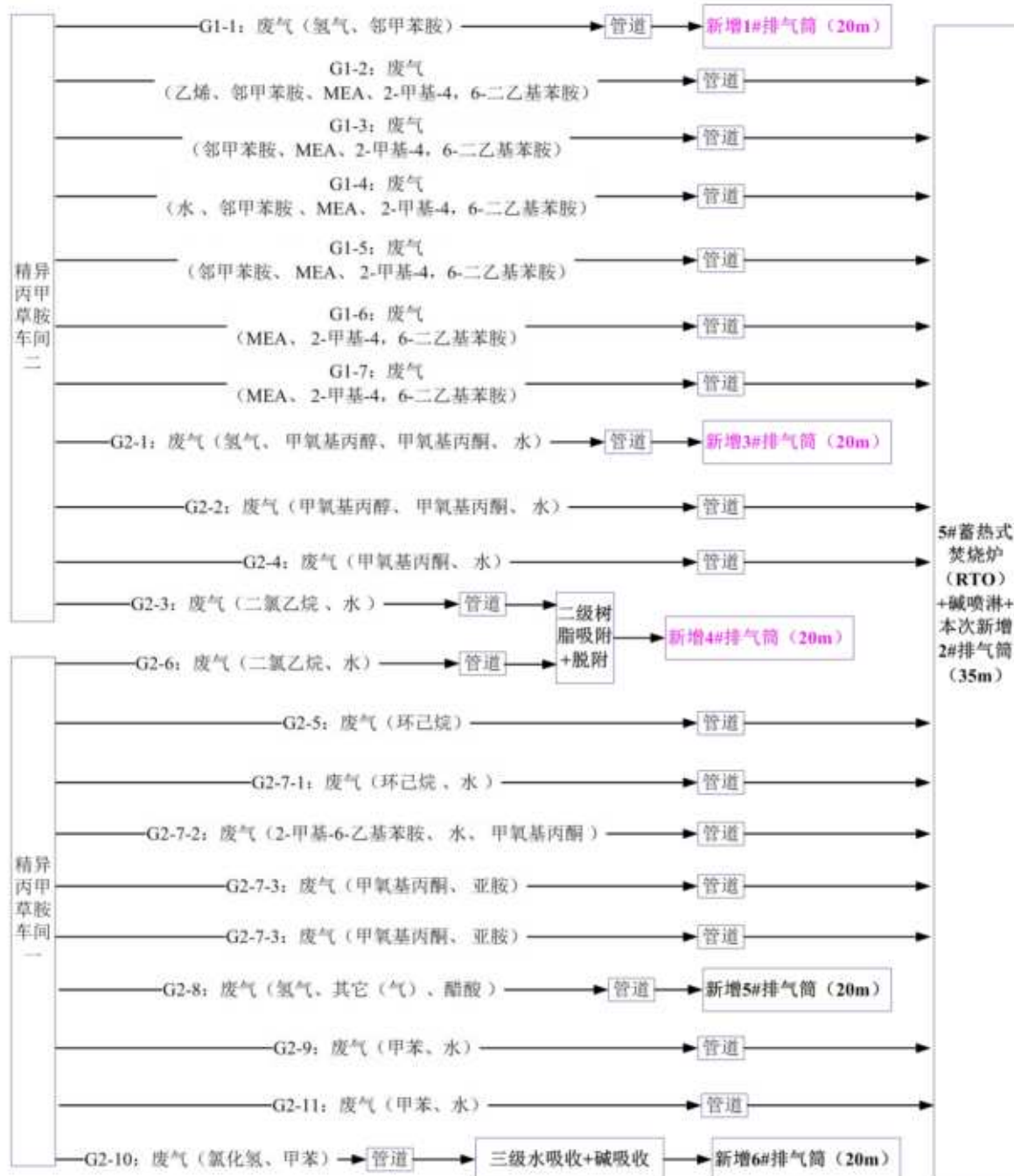
图 7.2-1 本项目废气收集治理措施图
