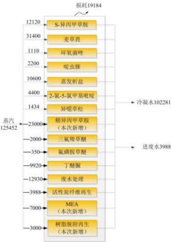
图 4.4-2 项目实施后全厂蒸汽平衡（单位：t/a）
