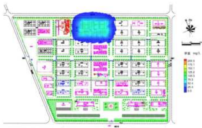
图 6.2-31 (a) 事故工况下污水处理站运行 100 天后甲苯运移分布图
